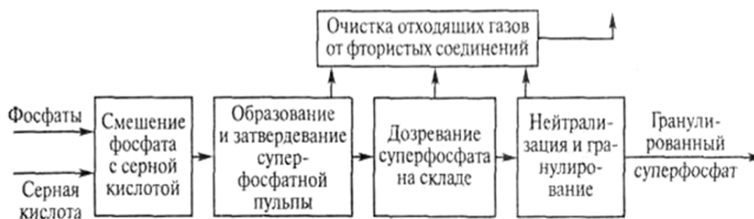
Рис. 3.11. Функциональная схема производства простого суперфосфата
