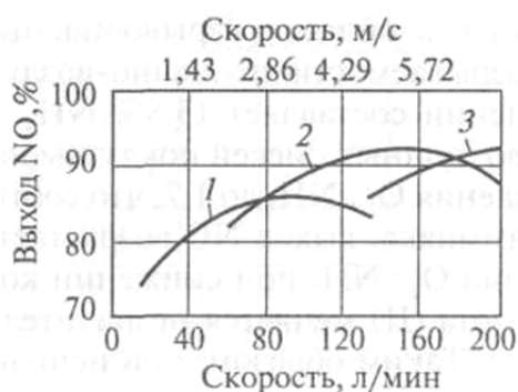
Рис. 2.20. Зависимость выхода оксида азота от скорости газа и числа сеток при давлении 1,96 МПа и температуре 900 °C:
