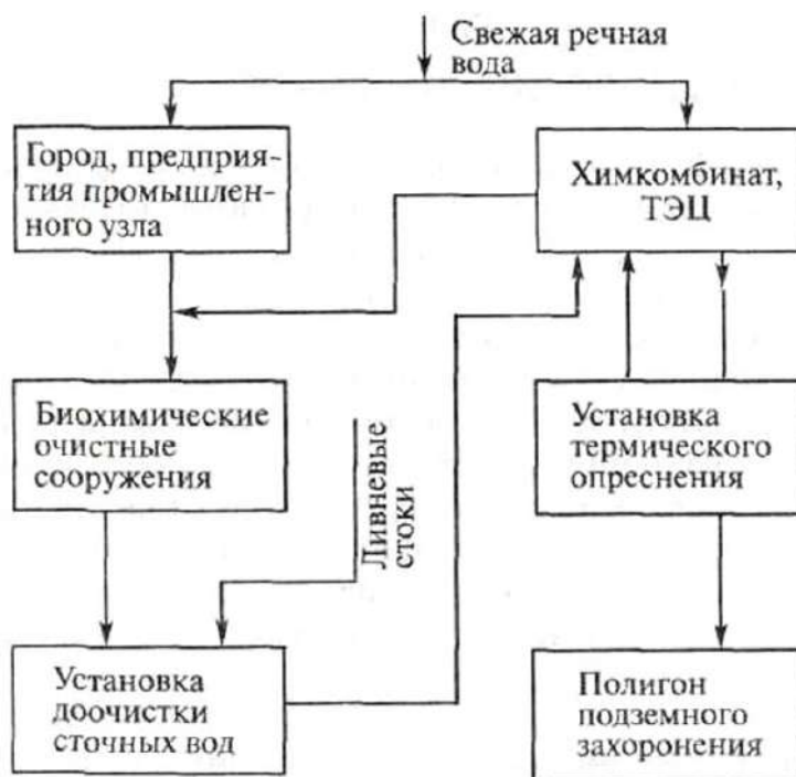
Рис. 1.11. Структурная схема водопотребления Первомайского химического комбината
