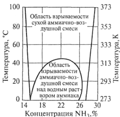
Рис. 2.21. Пределы взрываемости аммиачно-воздушной смеси
