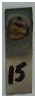
Рис. 78. Медная (а) и никелевая (б) подложки с областью образования графеновых слоев
