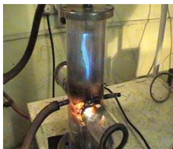
Рис. 7. Вольтамперная характеристика электрического разряда постоянного тока (а) [16] и фотография вида тлеющего разряда (б) [35]
