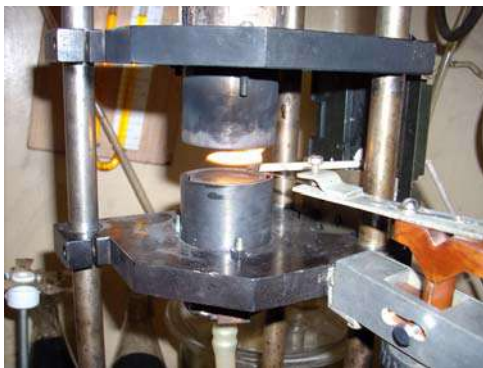
Рис. 76. Фото горелки при снятии пробы в разных температурных зонах пламени
