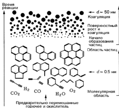
Рис. 1. Схематическое изображение процесса сажеобразования в гомогенных системах или в пламенах предварительно перемешанной смеси [5]
