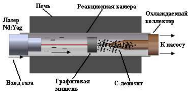
Рис. 43. Схема установки получения нанотрубок за счет лазерной абляции графитовой мишени [222]
