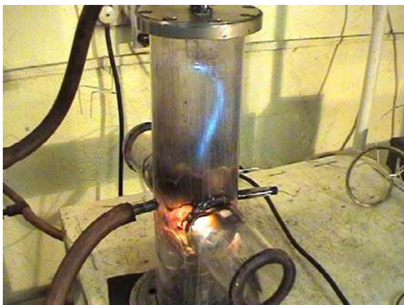
Рис. 59. Вид тлеющего разряда при межэлектродном расстоянии H=18 см [173]
