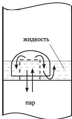
Рис. 4.11. Схема колпачковой тарелки
