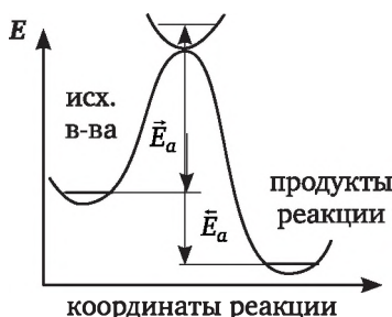
Рис. 6.12. Изменение потенциальной энергии взаимодействующих молекул в ходе химической реакции:
