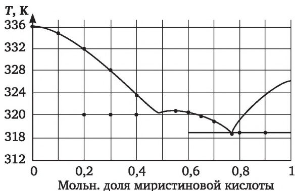
Рис. 4.28. Диаграмма плавкости системы миристиновая кислота — пальмитиновая кислота с химическим соединением, плавящимся конгруэнтно
