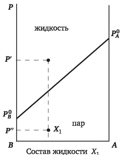
Рис. 4.5. Зависимость общего давления пара над идеальным жидким раствором от состава жидкости
