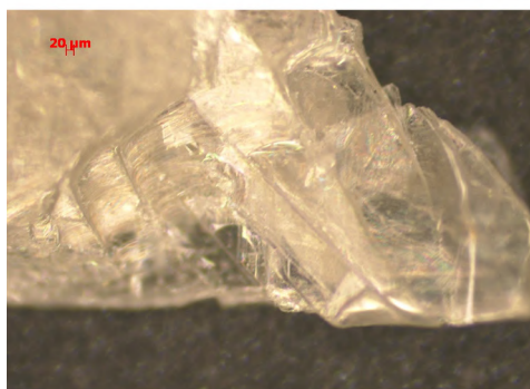
Рис. 3.19. Кристалл метастабильной фазы \text{PbGeO}_3 , полученный из метастабильного расплава спонтанной кристаллизацией
