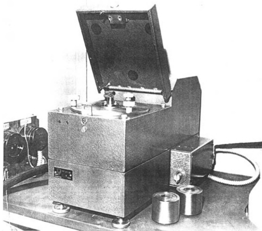
Рис. 2.1. Общий вид центробежно-планетарной мельницы АГО-2У
