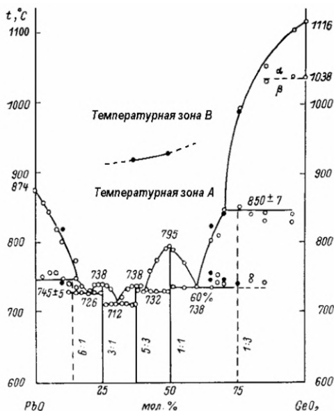
Рис. 3.13. Диаграмма стабильного равновесия системы PbO-GeO_2 [94] с экспериментально определенной границей двух температурных зон
