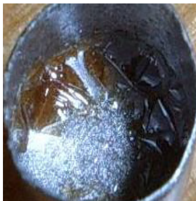
Рис. 3.42. Кристаллическая масса, образовавшаяся при кристаллизации стекла состава 40\text{GeO}_2-60\text{PbO}
