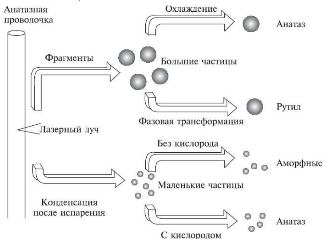
Рис. 62. Схема синтеза порошка диоксида титана при лазерном испарении подложки из TiO_2 .
