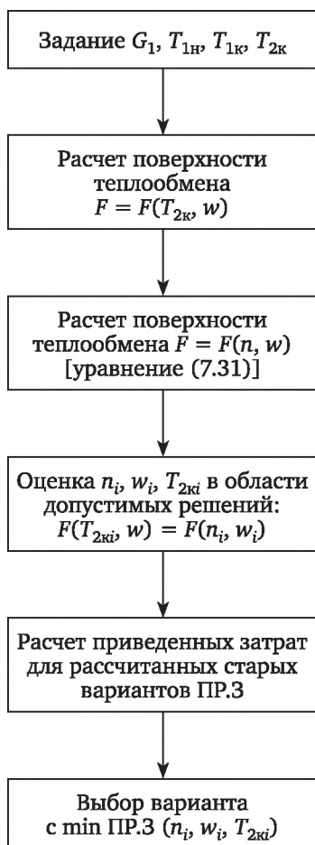
Рис. 7.8. Алгоритм расчета оптимальной конструкции теплообменника
