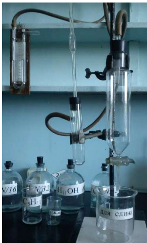
Рис. 8.2. Установка для определения поверхностного натяжения
