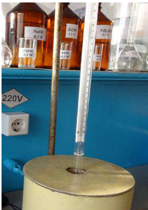
Рис. 2.1. Устройство калориметра
