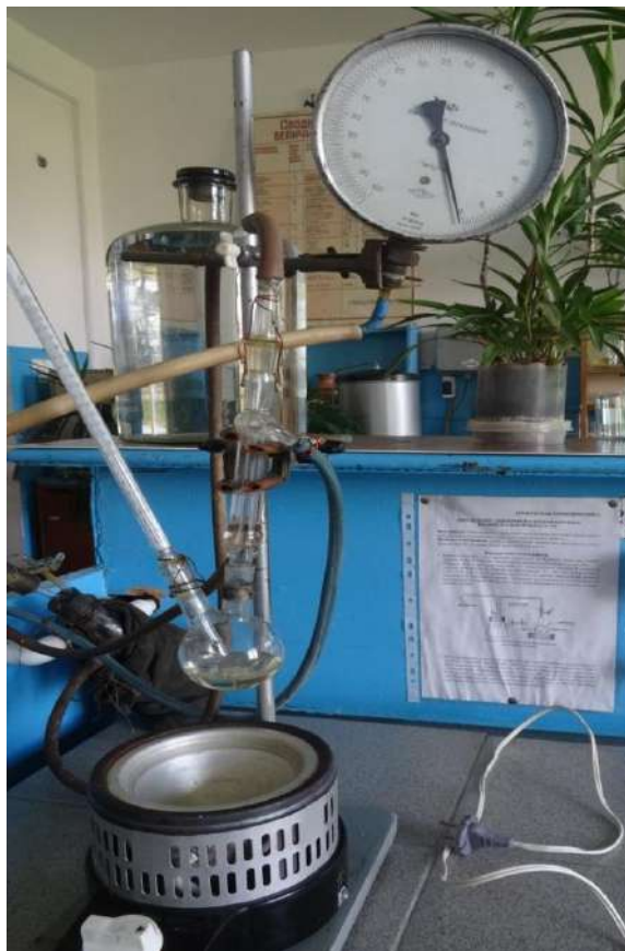
Рис. 4.2. Герметичная колба для изучения равновесия жидкость–пар
