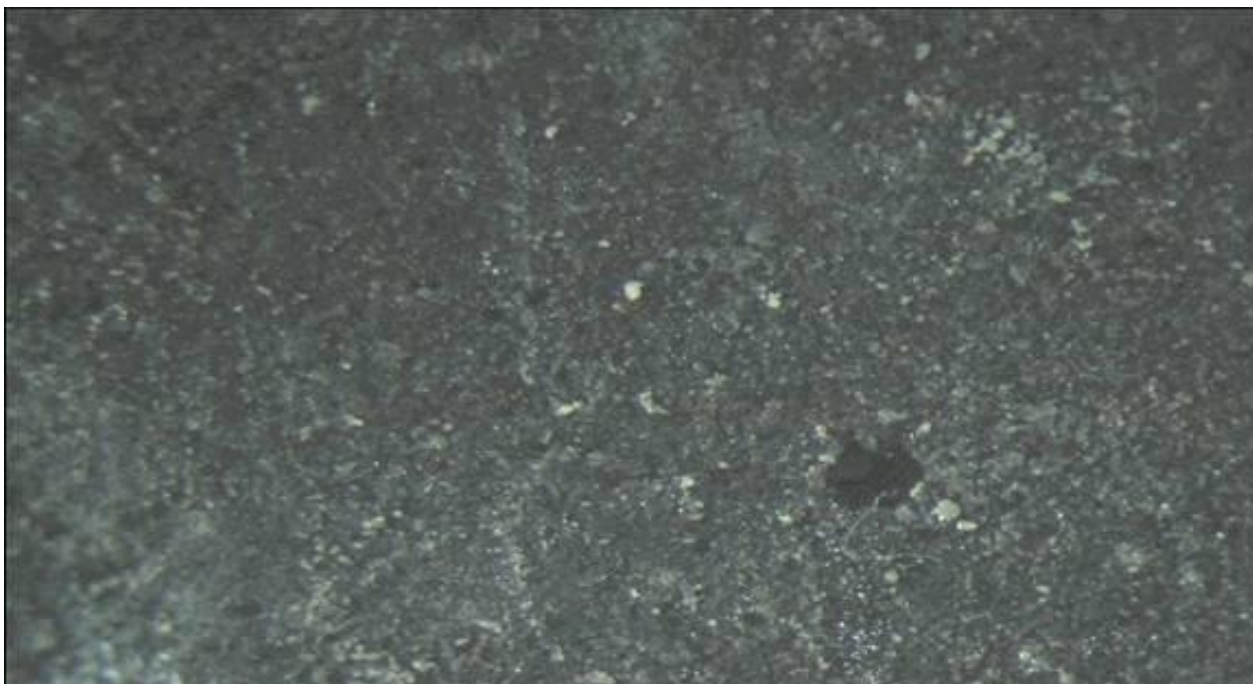
Рис. 2.11. Микрофотография поверхности серного композиционного материала на основе ЗШО, модифицированного хлоридом алюминия, полученного по технологии виброукладки. Соотношение сера:ЗШО составляет 1:1,5. Увеличение \times 32
