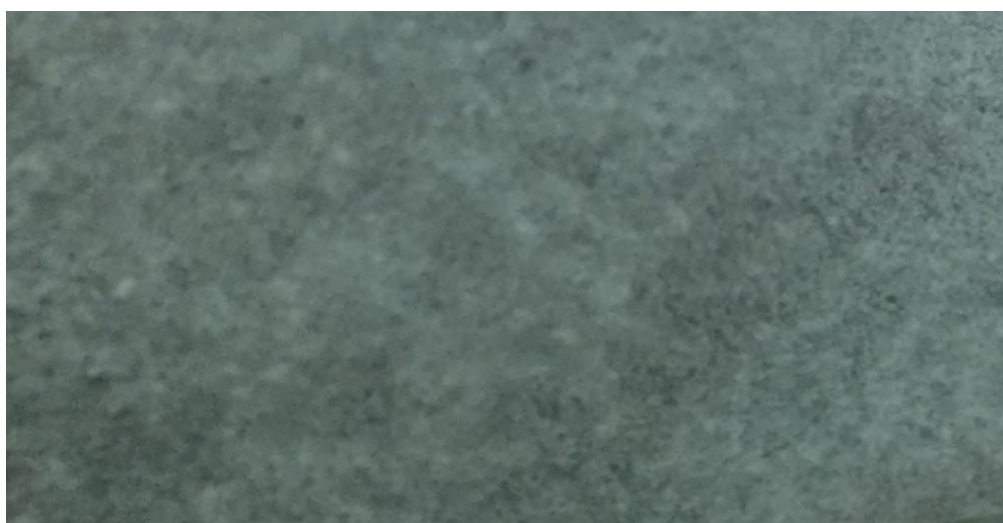
Рис. 5.12. Микрофотография образца радиационно-защитного бетона на основе отходов производства хлорида бария с добавлением ЗШО (33 %). Увеличение \times 30
