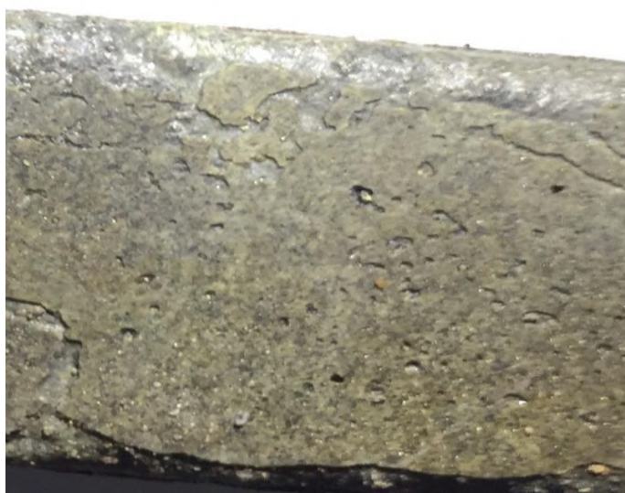
Рис. 5.11. Микрофотография поверхности серного композиционного материала на основе отхода производства \text{BaCl}_2 .
