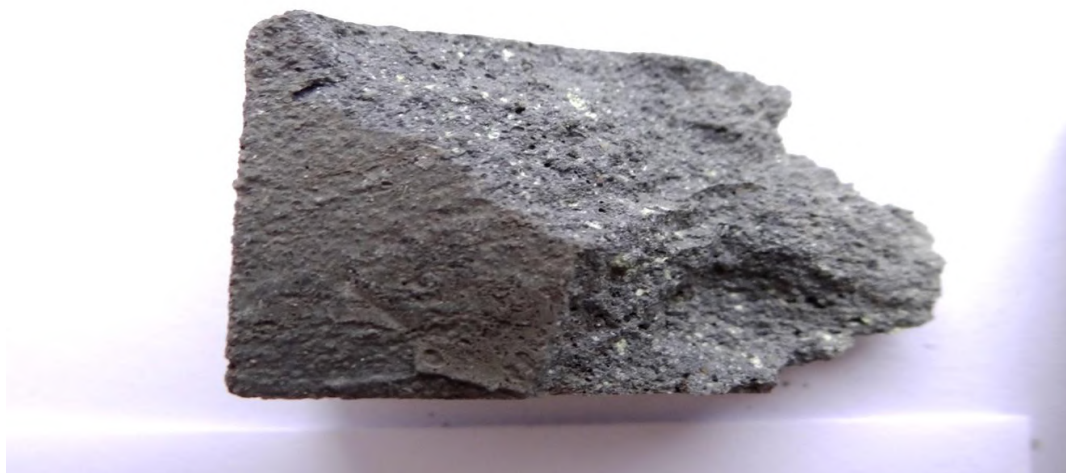
Образец 3 состава цементного бетона, пропитанного в 1 % модифицированном серном расплаве при 140 °С
