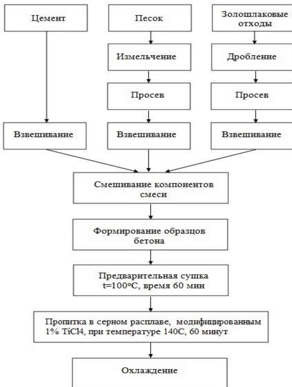
Рис. 4.12. Принципиальная блок-схема получения теплоизоляционных материалов на основе цемента, золошлаковых отходов теплоэнергетики и серных отходов нефтехимического комплекса
