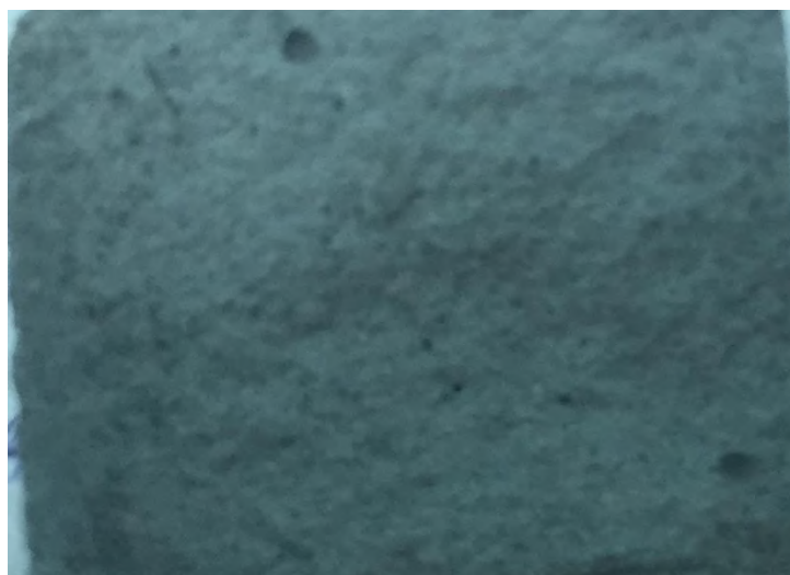
Рис. 5.6. Микрофотография образца радиационно-защитного бетона на основе отхода производства хлорида бария (99 %). Соотношение цемент:песок:отход производства хлорида бария составляет 1:0:3. Увеличение \times 30 .
