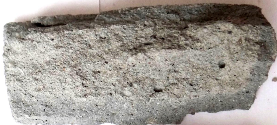
Образец 3 состава цементного бетона, пропитанного в 1 % модифицированном серном расплаве при 150 °С
