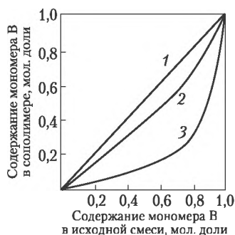
Рис. 4.12. Зависимость содержания в сополимере звеньев сомономера В от его содержания в исходной смеси при сополиконденсации дихлорангидрида изофталевой кислоты со смесью двух мономеров А и В:
