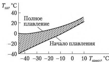
Рис. 6.17. Зависимость интервала плавления натурального каучука от температуры его кристаллизации
