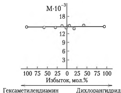
Рис. 4.32. Влияние соотношения исходных мономеров (варьирование объемов фаз) на молекулярную массу полигексаметиленадипамида, синтезируемого межфазной поликонденсацией на границе раздела фаз «жидкость — жидкость»
