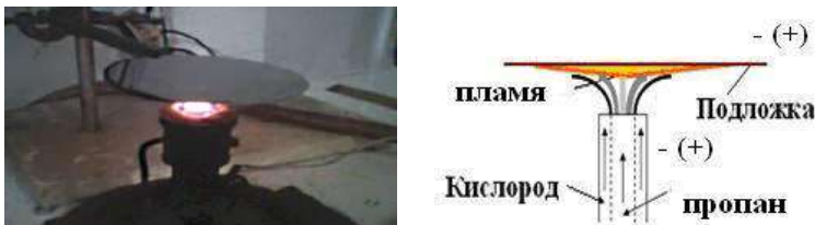
Рис. 6.15. Схема и фотография экспериментальной установки Время экспозиции воздействия пламени варьировалась от 4 до 10 мин.
