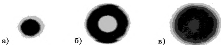
Рис. 4.3. Активация поверхностей золотых мишеней \alpha -частицами в статическом режиме облучения (а) и при их вращении (б, в) с одновременным отклонением пучка от центра мишеней
