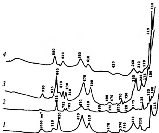
Рис. 3.19. Спектры КРС \text{LnNb}_2\text{VO}_9 ( \text{Ln} = \text{La} (1), \text{Pr} (2), \text{Sm} (3), \text{Gd} (4))
