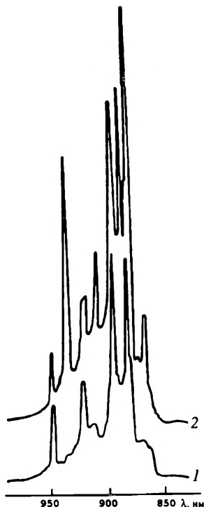
Рис. 4.4. Спектр люминесценции \text{La}_{0.98}\text{Nd}_{0.02}\text{TaO}_4 при 1600 К (1) и 1700 К (2)
