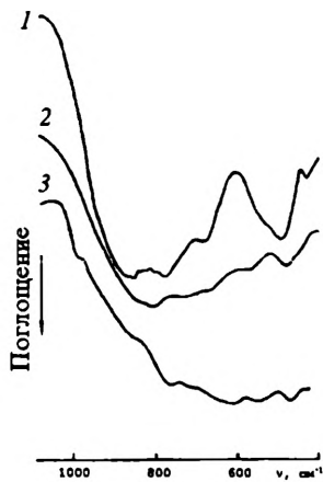
Рис. 3.17. ИК-спектры \text{LNNb}_2\text{VO}_9 ( \text{Ln} = \text{Er} (1), \text{Tm} (2), \text{Yb} (3), \text{Lu} (4))
