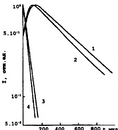
Рис. 4.45. Кривые затухания люминесценции с уровней {}^5D_1 и {}^5D_0 при температуре 80 (1, 3) и 300 К (2, 4). \lambda_{\text{в}} = 532 нм, \lambda_{\text{с}} = 615,9 (1, 2), \lambda_{\text{с}} = 554 нм (3, 4)
