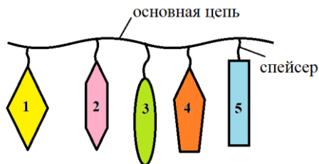
Рис. 30. Схематическое изображение макромолекулы гребнеобразного полимера с функциональными боковыми группами, отвечающими:
