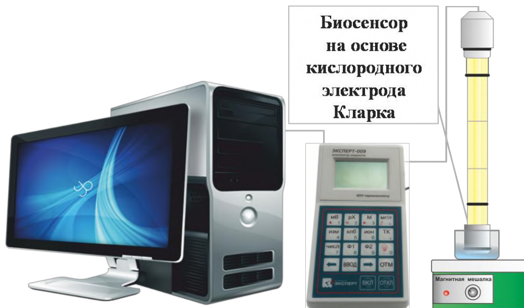
Рисунок 8.15 Биосенсорная установка на основе кислородного электрода
