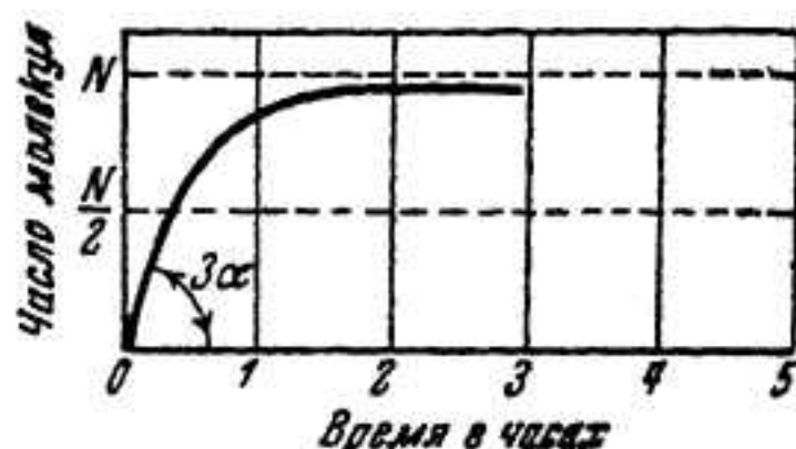
Рис. 36. Кривая быстрого процесса полимеризации
