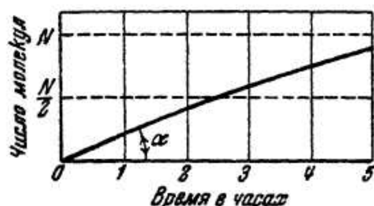
Рис. 35. Кривая медленного мономолекулярного процесса полимеризации
