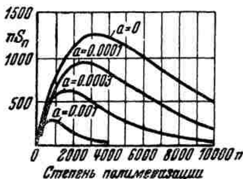
Рис. 11. Кривые распределения количества вещества по степеням полимеризации в различные моменты времени. Верхняя кривая соответствует исходному продукту ( \alpha = 0 )
